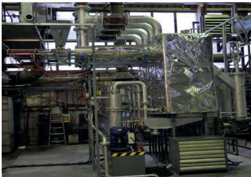
*Рис. 1.39. Установка ОИВТ РАН по отработке режимных параметров технологии конверсии местных топливно-энергетических ресурсов в газовое топливо. Мощность – 50 кВт эл.*
