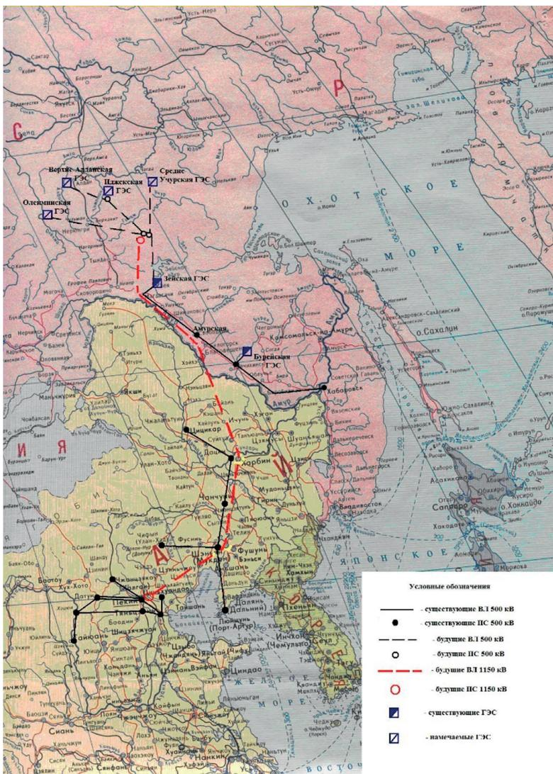
*Рис. 1.42. Электрическая связь ЮЯГЭК – Северная энергосистема Китая*
