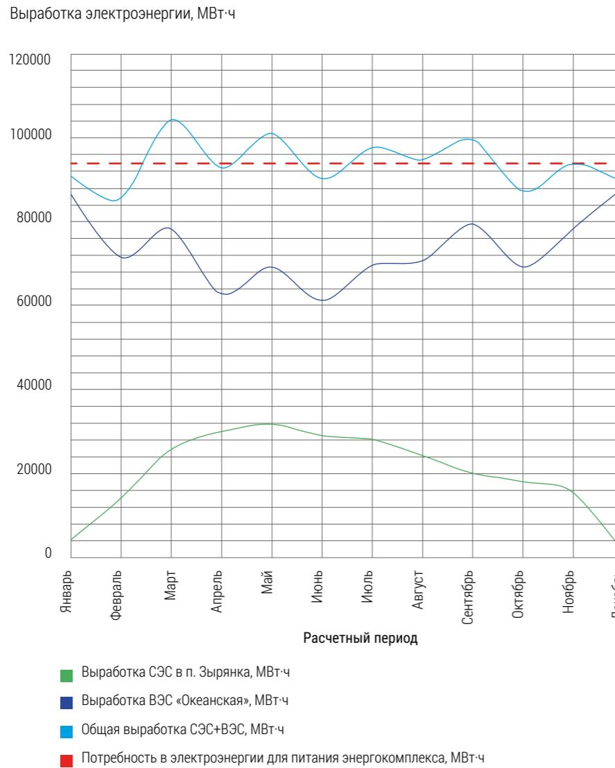
Рис. 3. Расчетная выработка электроэнергии солнечной электростанцией мощностью 150 МВт, ветряной электростанцией мощностью 170 МВт и суммарная их выработка в течение года в Республике Саха (Якутия)
